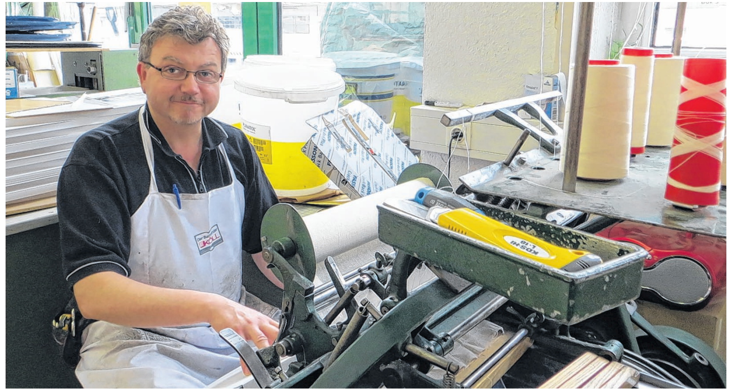
Buchbindermeister Peter Köll bedient eine 90 Jahre alte Fadenbindemaschine in seiner Werkstatt in Innsbruck.
